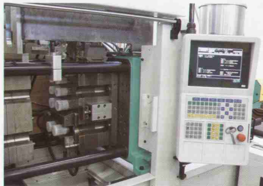
Hohe Produktivität: Am Ende eines Zyklus fährt das Handlingsystem in das geöffnete Werkzeug, entnimmt acht Bauteile und montiert sie oberhalb zu zwei Magazinen, während gleichzeitig acht neue Bauteile gespritzt werden. (Bilder: hej, Synventive)
