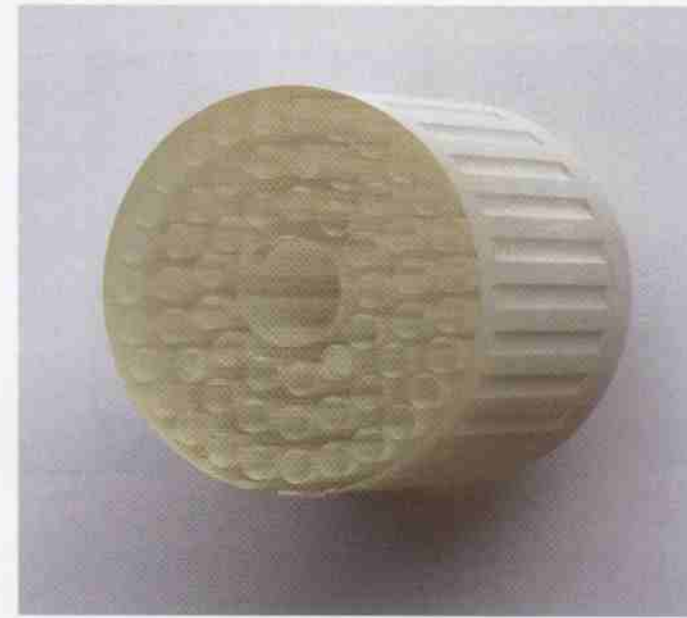
Das nach dem stereolithografischen Modell hergestellte Bauteil aus ABS (oben) war zu ungenau und zu schwer. Das fertigungsgerechte Konstruieren einer Baugruppe war zwar eine technische Herausforderung, verhalf aber der Erfindung zum Durchbruch.
