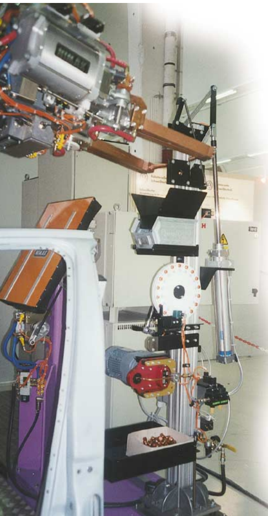
Kappen-Service-Center von Nimak: Das Abziehen der gebrauchten Schweißkappen von den Schäften der Schweißzangen erfolgt vollautomatisch. Bild: Nimak
