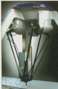
Der Roboter schafft über 100 ‚Picks‘ pro Minute. Bild: SIG
